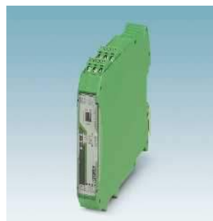
Módulos I/O analógicos, 4 entradas ou 4 saídas
