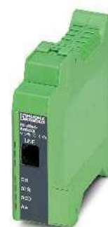
Modem por operação discada com conexão USB
