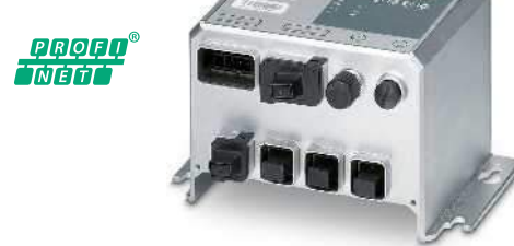
1 porta RJ45 e 3 portas POF SC-RJ, para montagem na parede
