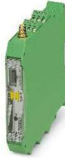
Transceptor de rádio de 868 MHz, para utilização sem licença na Europa
