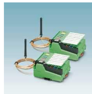
Módulos de rádio Bluetooth (2,4 GHz) Multiplex sem fio com antenas
