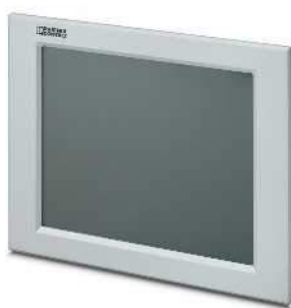
PC de painel configurável com tecnologia Intel® Core™ i3-4010U
