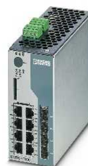
4 portas RJ45, 2 portas Fast Ethernet e 2 portas Combo Gigabit (SFP ou RJ45)
