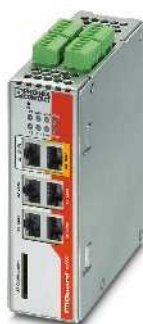
Roteador com firewall inteligente e switch integrado
