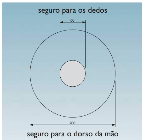
Exemplo: Acionamento por pressão
