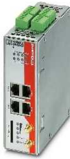
Roteador de telefonia móvel UMTS/HS-PA com firewall e VPN, switch integrado de 4 portas
