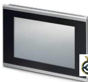
PC de painel configurável com tela de 22,9 cm (9"), com tecnologia Intel® Atom™ E3845
