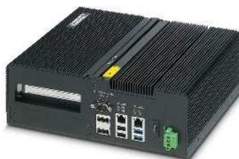
Box PC com tecnologia Intel® Core™ i5-4300U e slot PCI/e
