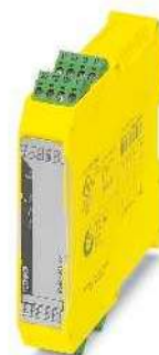
3 circuitos de corrente de liberação, 1 circuito de corrente de retorno, com certificação para uso em elevadores conforme EN 81-20
